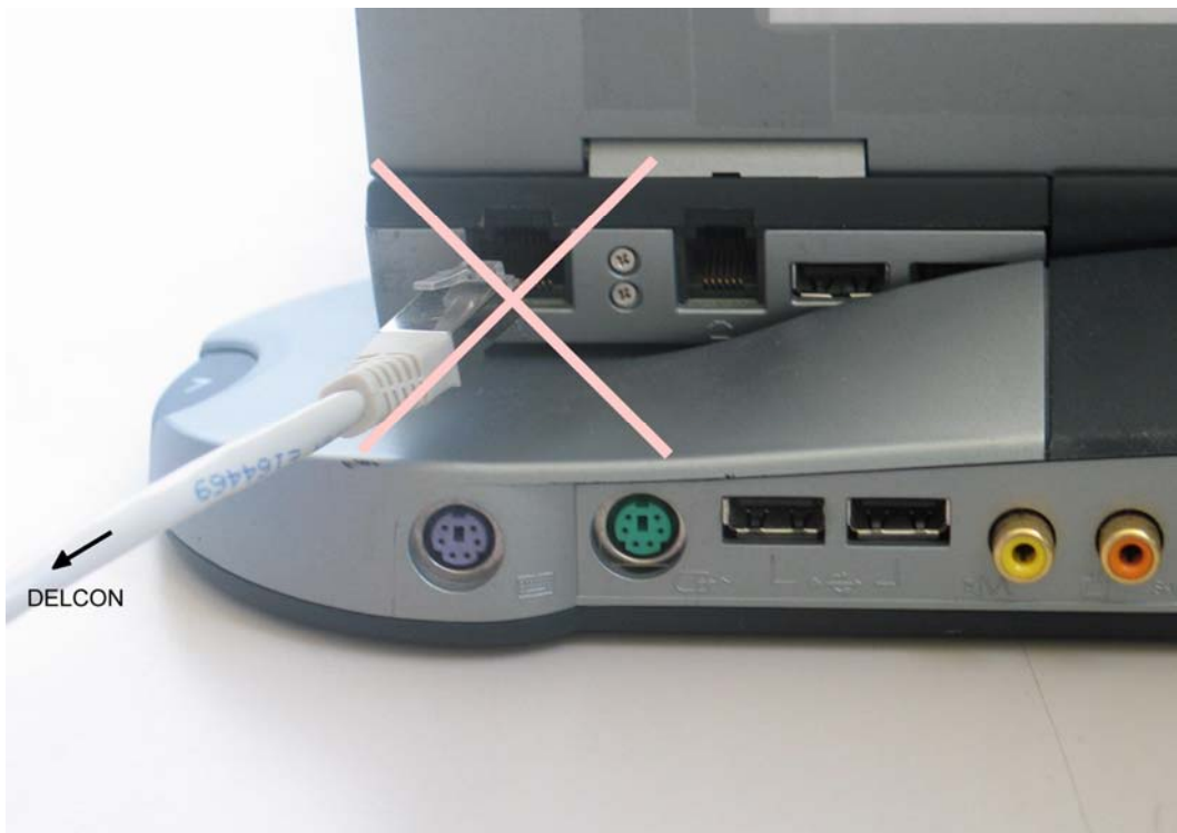
No conectar el DELCON a la interfaz Ethernet!
