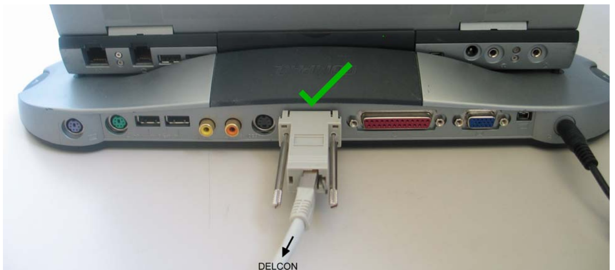
Conexión a interfaz de serie con adaptador Bucher
